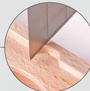
Удалите монтажным ножом или напильником перемычку, закрывающую паз.
